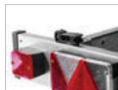
Fixation rapide pour démontage rapide de la rampe de feu
