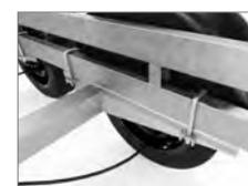
Ejes regulables. Cambiando la distancia entre ejes puedes combinar el peso de una manera óptima.
