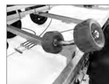
X-line - equipados con rodillos laterales dobles para una mayor protección de tu barco.
