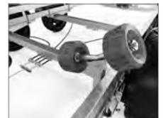
x-line - equipados con rodillos laterales dobles para una mejor protección de tu barco.
