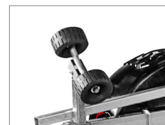
Dubbla multijusterbara X-line-sidorullar bak
