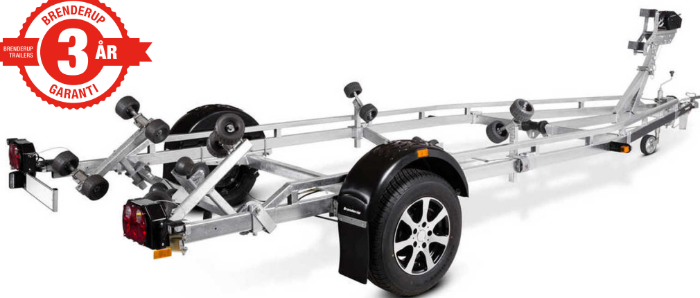
Dubbla multijusterbara X-line-sidorullar fram
