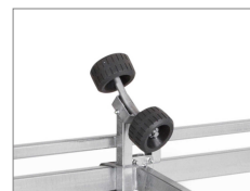
Dubbla multijusterbara X-line-sidorullar fram
